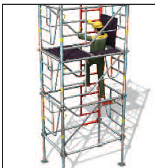
> 10- Le premier niveau de plancher peut être enlevé. Accès au niveau supérieur par l'échelle intégrée.
