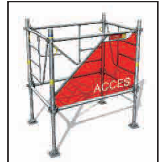
> 3- Pose du cadre d'entrée de 1,50 m qui facilite l'accès.
