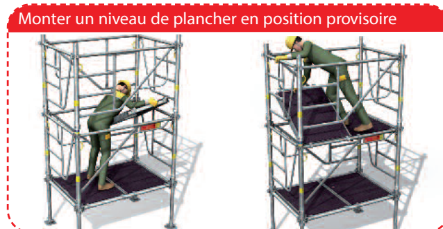
> 5- Pose d'un 1 er plancher à trappe de 1 m.
