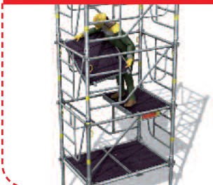
> 8- Déplacement du 1 er plancher à trappe.
