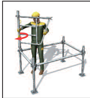
> 2- Depuis l'intérieur de la tour, pose du 1 er cadre dans l'axe de la diagonale puis rotation pour le verrouiller.
