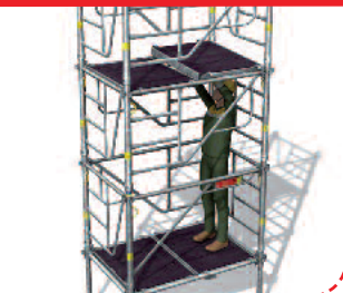
> 9 - Déplacement du 2 e plancher à trappe depuis le niveau inférieur.
