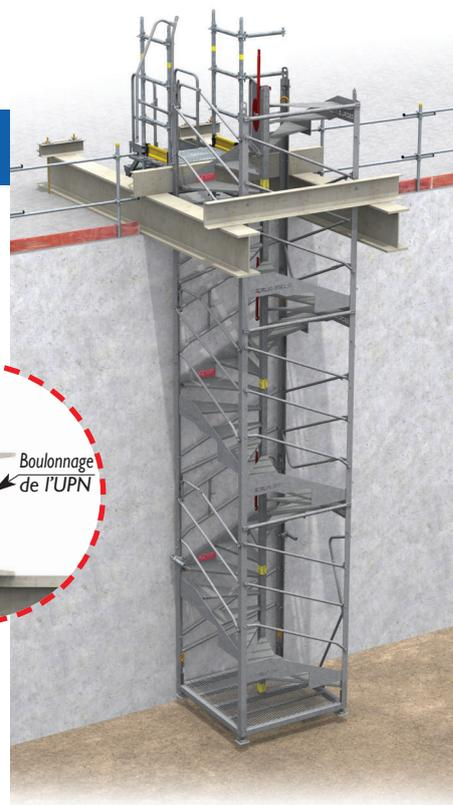
Schéma d'un Escalib Mills MDS suspendu pour accéder au fond de fouille.
