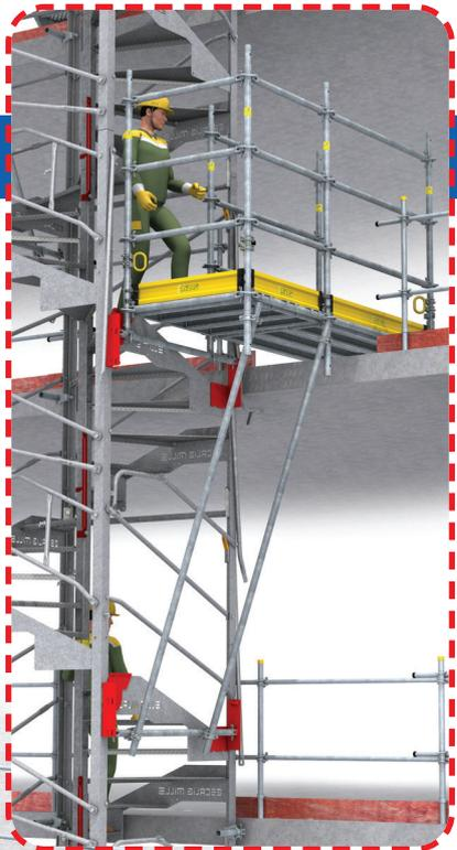
La passerelle en console est soutenue par 2 tubes Ø 49 fixés au niveau inférieur sur une lisse de 1,50 m solidaire de 2 "supports passerelle".
