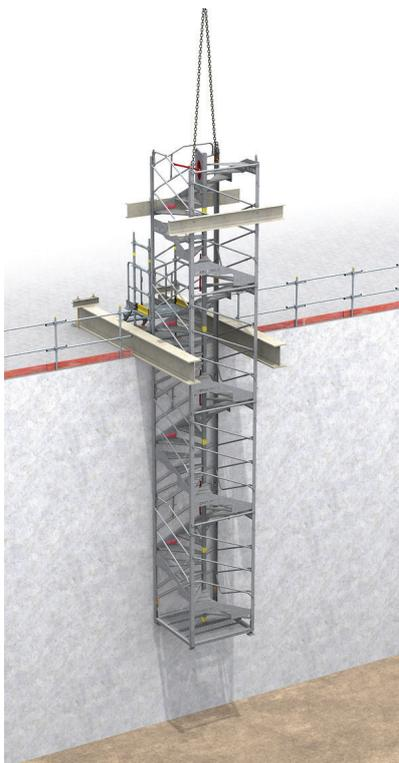
> **2** - Assemblage des modules. Remettre la lisse de montage en position verticale. Mise en tension des élingues de la grue. Démontage des amarrages et des 2 UPN en appui sur les HEB.
