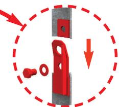
Assemblage des montants latéraux avec vis M24 et clé de 36.
