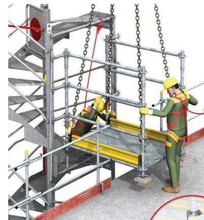
> **3** - Dépose du garde-corps de rive de dalle. Pose de la passerelle. Dépose provisoire des colliers de vérin pour réglage de l'altimétrie. Serrage des colliers de reprise.
