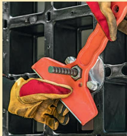
Particulièrement judicieux : l'outil universel peut également être utilisé pour le vissage de l'écrou disque.
