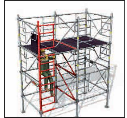
> 10 - Le premier niveau de plancher peut être enlevé. Accès au niveau supérieur par l'échelle intégrée.
