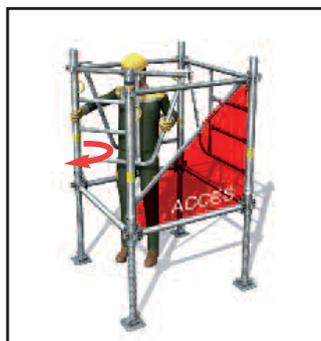
> 1 - Implantation et mise à niveau. Pose des cadres du 1<sup>er</sup> niveau avec un cadre d'entrée.
