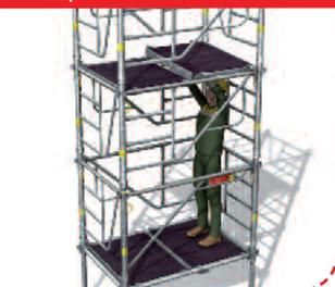
> 9 - Déplacement du 2<sup>e</sup> plancher à trappe depuis le niveau inférieur.
