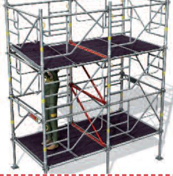
> 9 - Déplacement du 4<sup>e</sup> plancher à trappe depuis le niveau inférieur.
