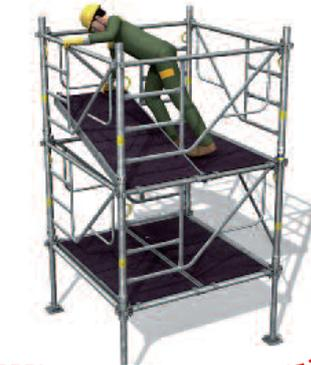
> 6 - Accès au niveau supérieur puis pose du 2<sup>e</sup> plancher à trappe.
