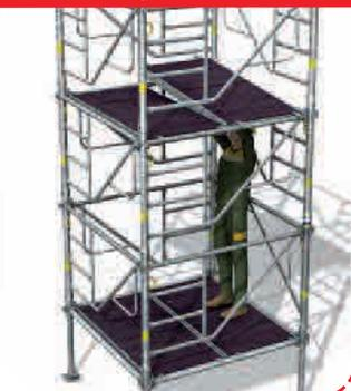
> 9 - Déplacement du 2<sup>e</sup> plancher à trappe depuis le niveau inférieur.
