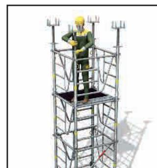
> 7 - Le 1<sup>er</sup> niveau de plancher peut être enlevé. Accès au niveau supérieur puis mise en place et réglage des vérins de tête.
