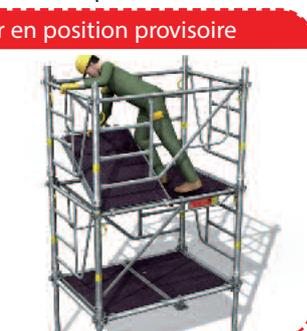
> 6 - Accès au niveau supérieur puis pose du 2<sup>e</sup> plancher à trappe 1 m.
