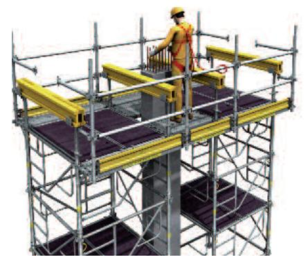
> 1 - Le montage du platelage s'effectue en sécurité collective depuis un niveau de plancher en position provisoire.
